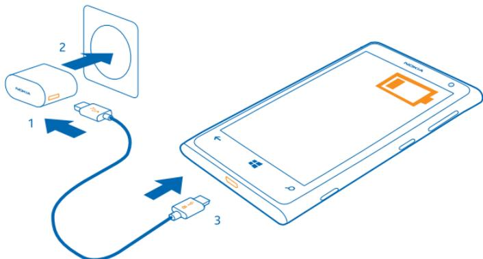
3. После полной зарядки аккумулятора отключите зарядное устройство от телефона, а затем от сетевой розетки.
