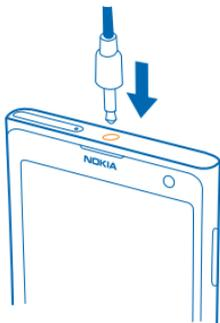
Не подключайте аппаратуру, которая формирует выходной сигнал, поскольку в результате устройство может оказаться повреждено. Не подключайте источники напряжения к звуковому разъему. При подключении к аудиоразъему внешнего устройства или мини-гарнитуры, отличных от рекомендованных для данного устройства, уделите особое внимание уровню громкости.
